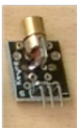
Laser (in Verbindung mit Lichtsensor als Lichtschranke einsetzbar)
